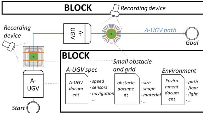
**FIGURE 3:** THE CONCEPTUAL PICTURE OF THE GRID-VIDEO MEASUREMENT METHOD FOR SMALL OBSTACLE AVOIDANCE PERFORMANCE MEASUREMENT
