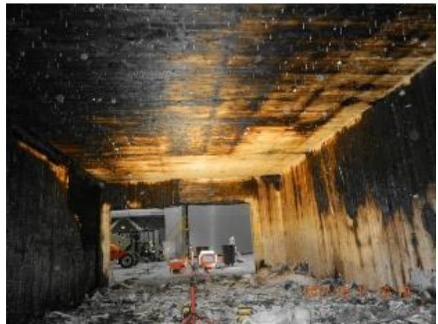
(d) W1, W2, W3 and ceiling CLT after Test 1-3.
