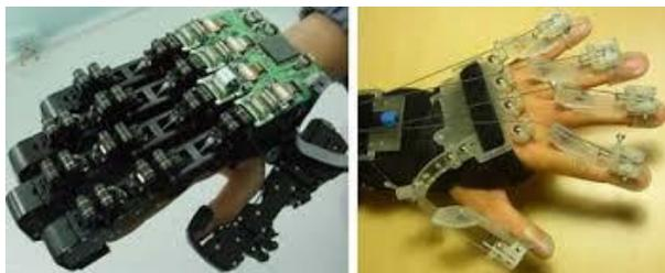
Figure 7. Example hand exoskeletons (courtesy Politecnico di Torino) [24].
