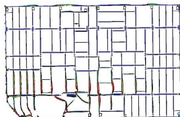
(d) Floor 80 core framing damage
