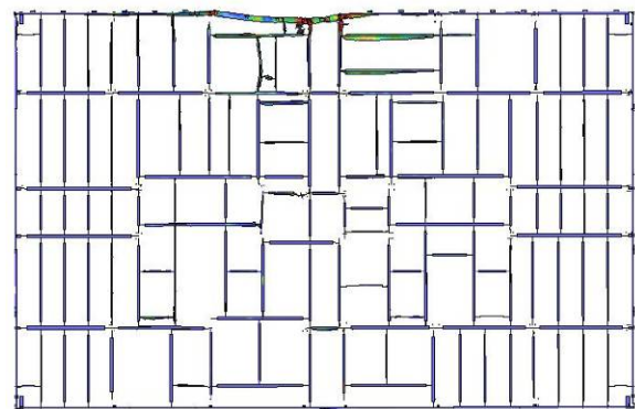
(d) Floor 96 core framing damage
