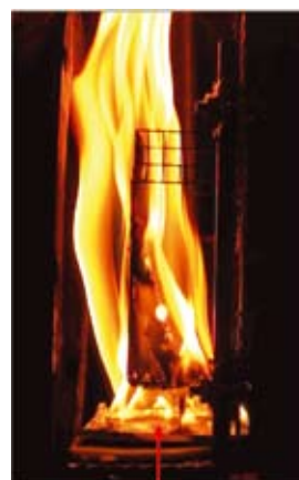
Pool-fire (Standard FR PU Foam)
