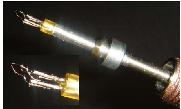
**Fig. 6** 0.05 mm thermocouple pair.
