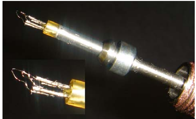
Fig. 6 0.05 mm thermocouple pair.
